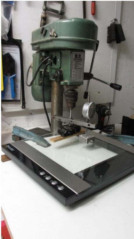
Abbildung 2: Versuchsaufbau zur Messung der Federkonstanten
