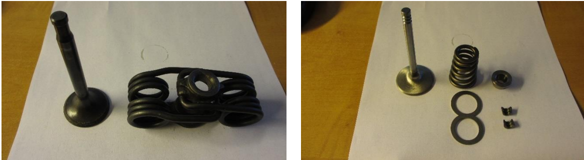
Abbildung 1: Standard Maxventil mit Haarnadelfeder (links); OBS Ventil mit Schraubenfeder, U-Scheiben, Federhalter und Keile (rechts)
